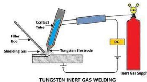
**Fig1: TUNGSTEN INERT GAS WELDING.**
